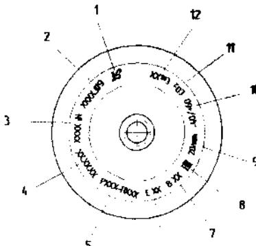
Рисунок 1 - Пример маркировки баллона
